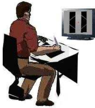
FIG. 3.3. – Dispositif expérimental. Les sujets sont assis en face de l'écran et utilisent un stylet posé sur une tablette graphique dans les tâches actives de conduite et de poursuite de cibles. La main active est masquée à l'aide d'un cache en bois qui recouvre la tablette (non figuré sur le schéma). Un clavier est disposé à côté de la tablette graphique pour les réponses de localisation.
